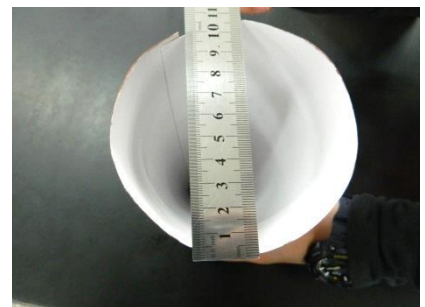
圖 42:角度 12 時，出聲口直徑大
