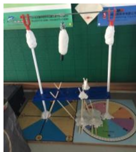
底座下方加入竹筷增加接觸面積下方 支架加上黏土增重【圖 3-6】
