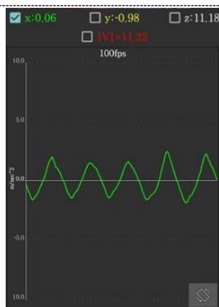
Vibration Alarm 顯示的搖晃 力道【圖 8-2】
