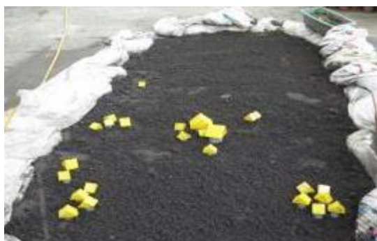
誘發土石流發生前
