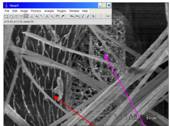
用 ImageJ 軟體量測腹部細毛間距與氣孔孔洞直徑。
