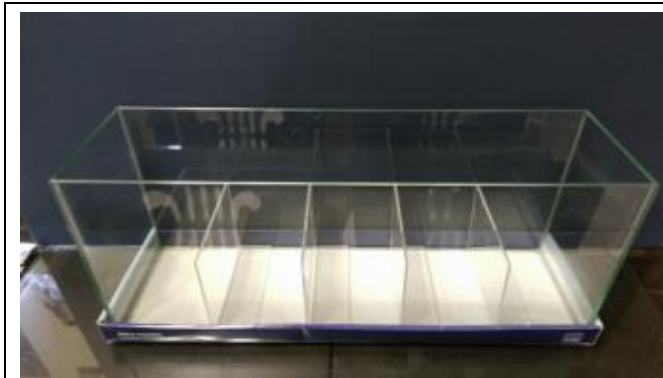
實驗缸利用 12 公分高的透明壓克力板平均分 5 個區塊
