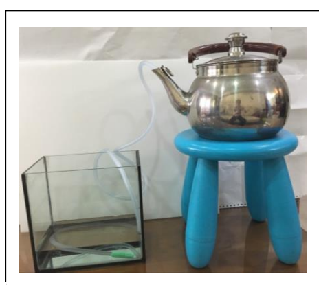
圖 7 利用虹吸式原理，將開水引入實驗缸中
