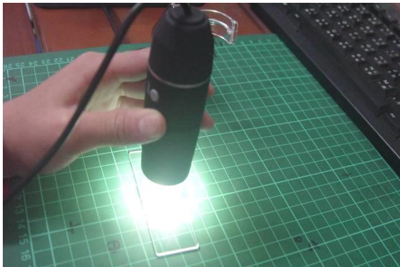
照片 1-3：利用 USB 顯微鏡掃描內部結構的表面
