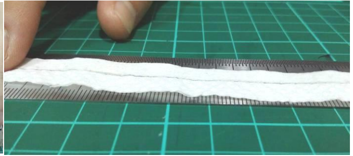
照片 11-1：測量乾燥後吸水紙頭尾兩端距離 照片 11-2：未貼透氣膠帶處產生捲曲
