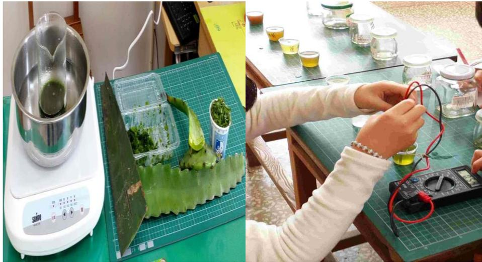
圖十二 用三用電表測量不同植物的葉綠素液的電壓與最大電流量
