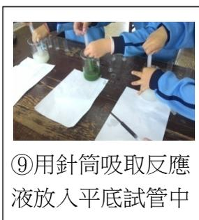
⑨用針筒吸取反應液放入平底試管中
