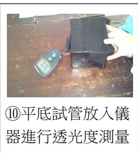
⑩平底試管放入儀器進行透光度測量
