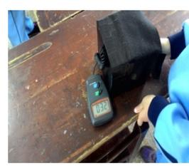
⑩平底試管放入儀器中進行透光度測
