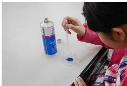
圖 4-5-2 將各種溶劑滴入感溫粉中
