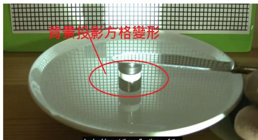
圖二水面上的投影的方格,因為水的反磁性凹陷,扭曲變形
