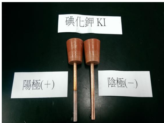
圖 8-5-1 銅—電解碘化鉀電極變化
