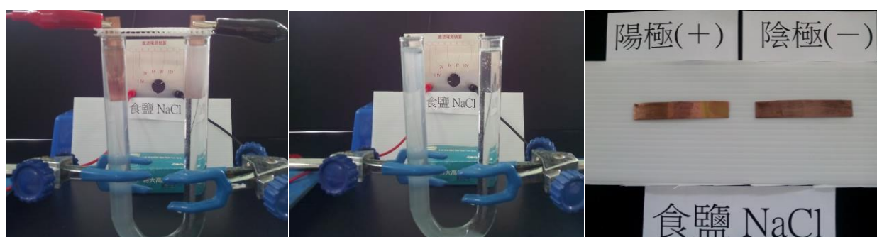
圖 7-4-1 銅—U 型管電解食鹽水 圖 7-4-2 銅—U 型管電解食鹽水 圖 7-5-1 銅—電解食鹽水電極變化
