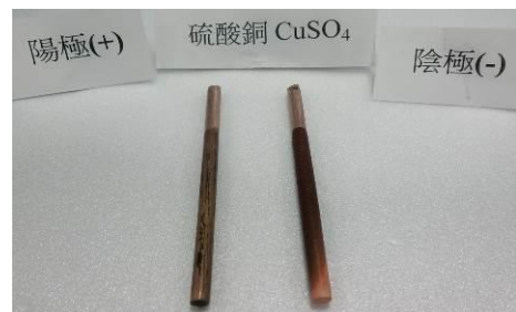
圖 9-6-1 銅—加溫電解硫酸銅電極變化
