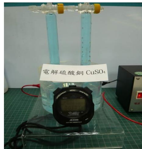
圖 9-4-1 銅--電解硫酸銅氣體體積測量
