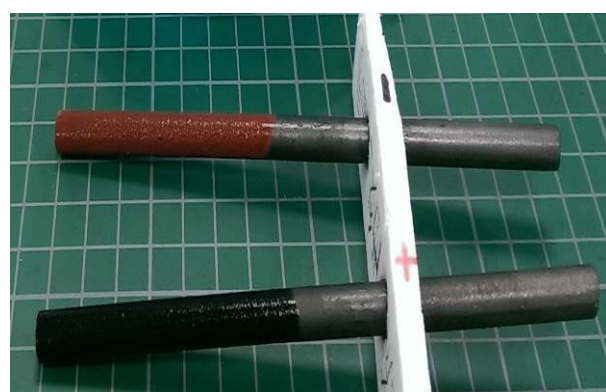
圖 9-7 冰溫電解硫酸銅電極的比較
