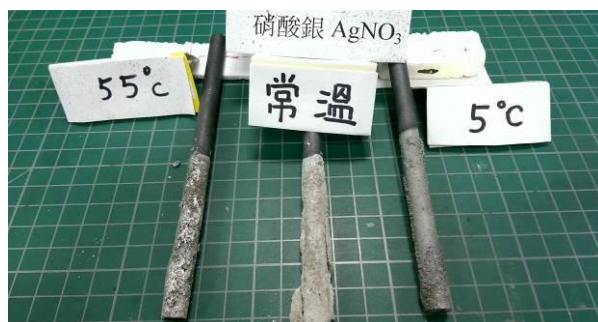
圖 9-8 電解硝酸銀不同溫度陰極比較
