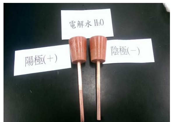
圖 6-7-1 銅—電解水電極變化
