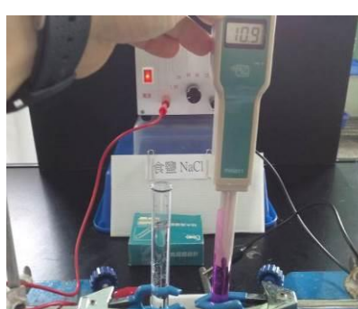
圖 7-5 電解食鹽水 pH 計檢測
