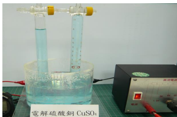
圖 9-4 電解硫酸銅氣體體積測量
