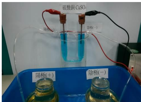
圖 9-3-1 銅--電解硫酸銅氣體收集與檢驗
