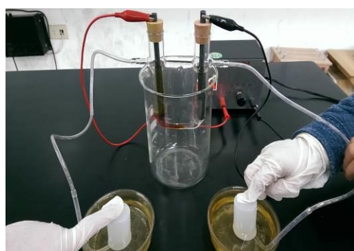
圖 8-7 電解碘化鉀氣體收集與檢驗
