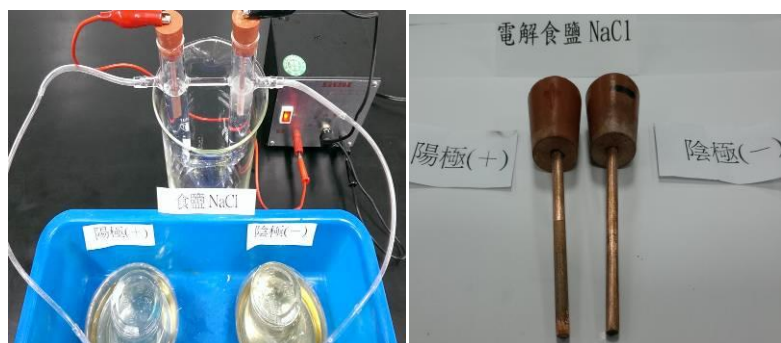
圖 7-8-1 銅—電解食鹽水氣體收集 圖 7-9-1 電解食鹽水銅電極
