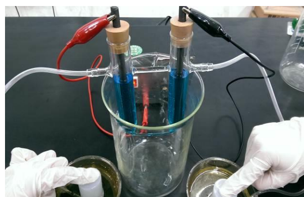
圖 9-5 電解硫酸銅氣體收集與檢驗
