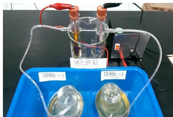
圖 8-3-2 銅—電解碘化鉀氣體收集與檢驗(5分鐘)
