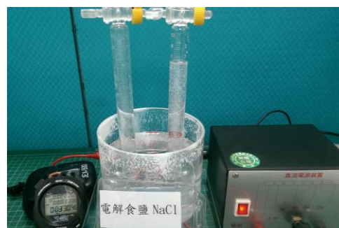
圖 7-7-1 銅—電解食鹽水氣體體積測量
