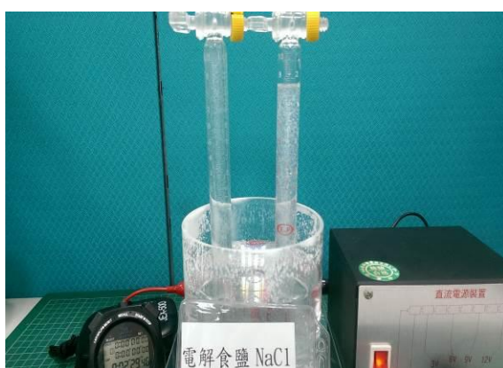
圖 7-7 電解食鹽水氣體體積測量
