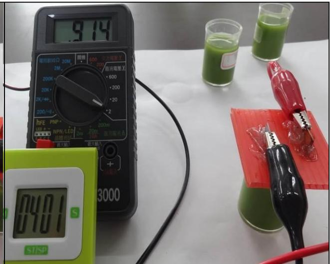
實驗二-2：加小蘇打(pH6.26)電壓**0.914V**
