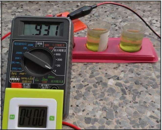
實驗二-3：太陽光下(>20000lux)電壓0.931V
