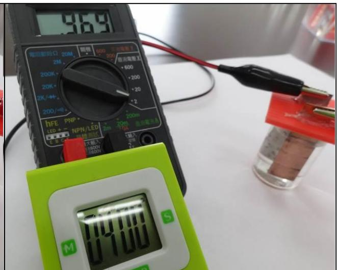
實驗二-2：純小蘇打水(pH8.10)電壓**0.969V**
