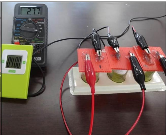
實驗七：3組葉綠素液串聯電壓2.77V
