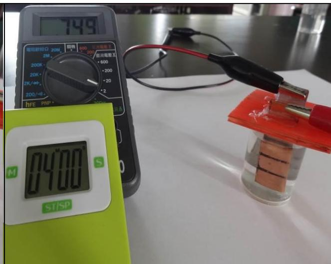
實驗二-2：RO水(pH7.35)電壓**0.749V**
