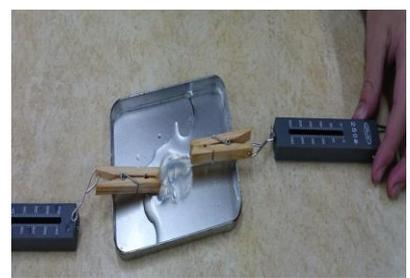
抓著一端，另一端往後拉，水球破掉時，觀察記錄水球能承受的水平拉力。
