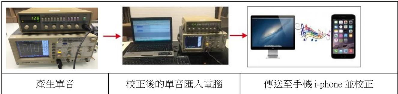
圖 6-3 128Hz、512Hz 和 1024 Hz 單音產生流程
