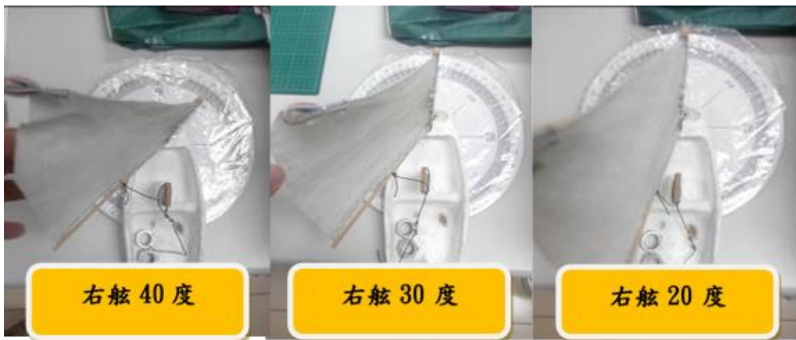
圖 19：用量角器調整操帆的角度，右舷 40 度、30 度、20 度。
