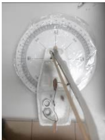
圖 3：利用方位盤作為量角器設定操帆角度
