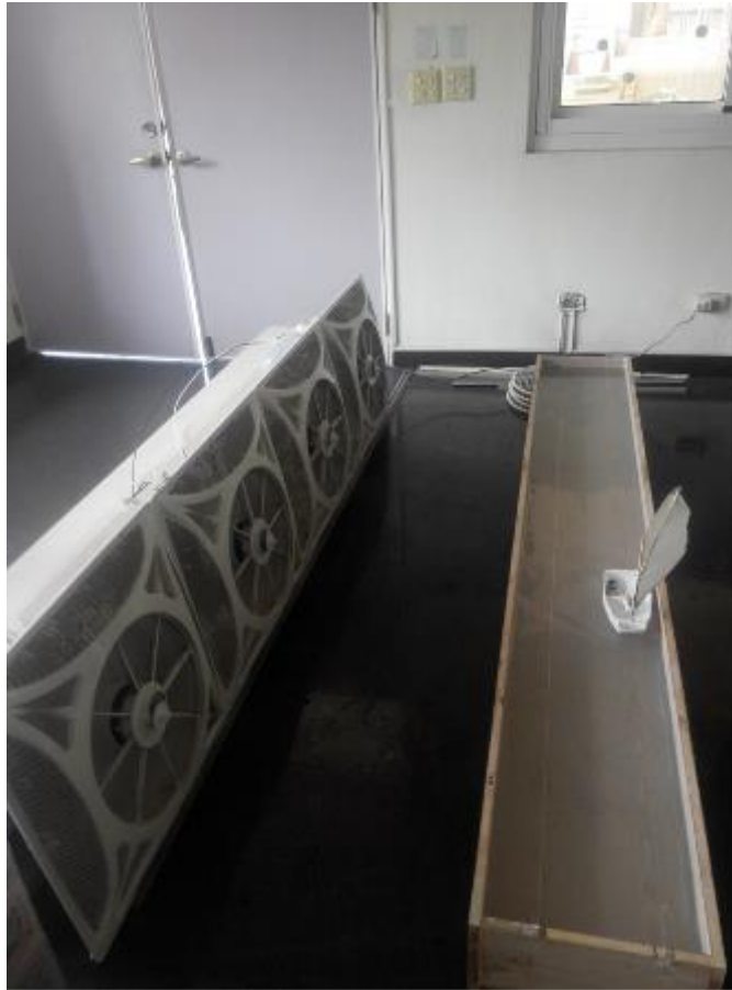
圖 15：使用電扇製造側風航行實驗照片
