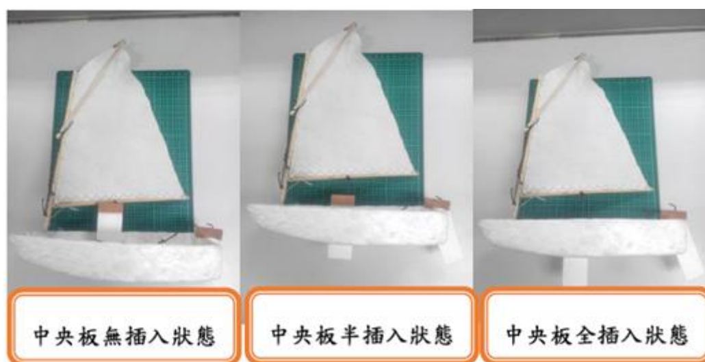
圖 24：三種中央板插入狀況進行實驗
