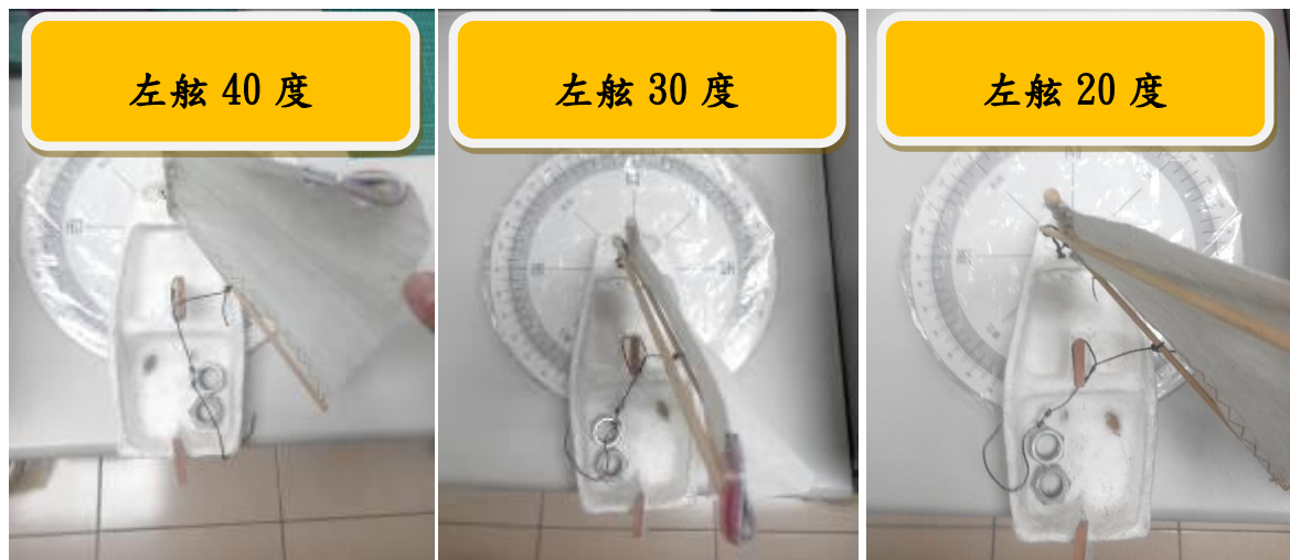
圖 20：用量角器調整操帆的角度，左舷 40 度、30 度、20 度。
