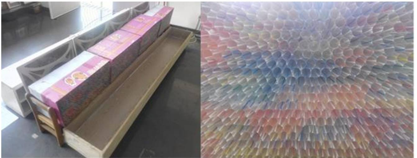
圖 18：利用粗吸管製作整流風洞牆，並架設在電扇風牆前
