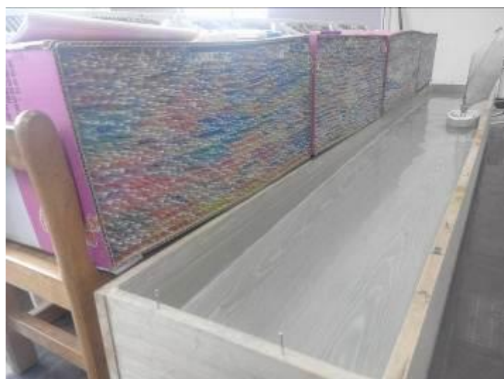
圖 21：使用風洞整流電扇風牆製造穩定側風進行各種操帆角度航行
