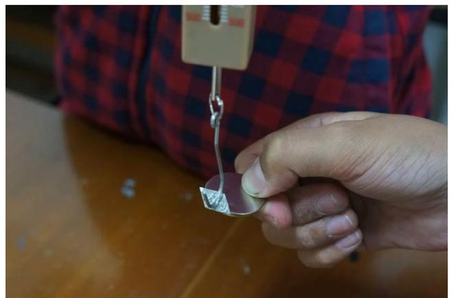
圖 7.4 不同接觸面積量測磁拉力情形
