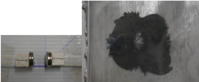
圖 7.10 磁相斥 0 度磁力線鐵粉分佈情形
