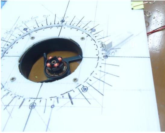
圖 5.6 直流馬達測試平台
