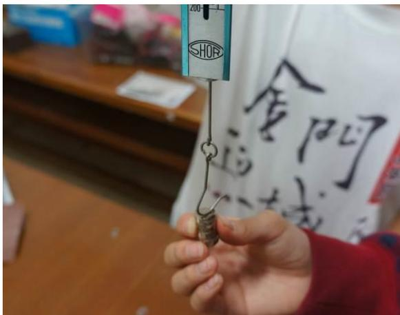
圖 7.3 串聯磁鐵數量測磁拉力情形
