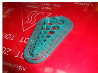
圖 40：印製出來的錐螺中心縱切片 3D 模型。
