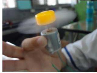
圖 12：馬達裝上軟風扇，測試轉動效果。
