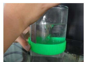
圖 10：改用魔鬼氈標示深度，拆卸方便。
