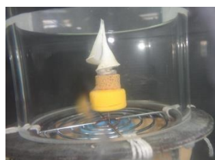
圖 25: 檢測旋梯螺製造漩渦的效果。
