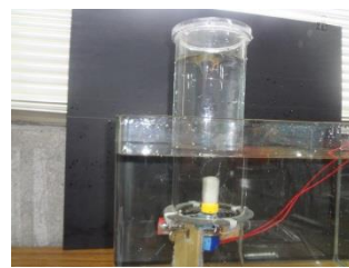
圖 18: 長方體製造漩渦的效果不太好。
