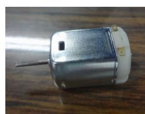
圖 63：最後最常用的是「強扭力直流馬達」。
