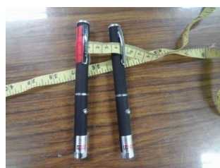
圖 5：完成的雷射筆測量工具，一支雷射筆黏貼布尺，另一支可移動
