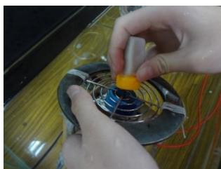
圖 17: 將長方體黏在平台，固定在馬達上。
