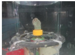
圖 20：測試豹斑玉螺開口在下的漩渦效果。
