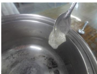
圖 15: 熱塑水晶放入熱水中就會變軟，能塑形
