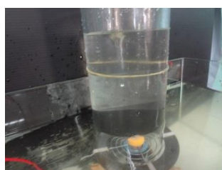
圖 8：用橡皮筋標示漩渦深度，但不好移動。
