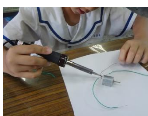
圖 62：焊接圓形馬達連接電線需焊接，很麻煩
