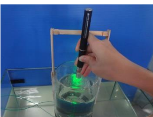
圖 3：將雷射筆固定在瓶子，但發現漩渦中心點不一定是圓筒中間
