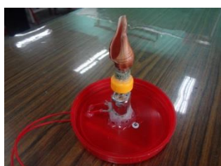
圖 56：將強扭力直流馬達黏在蓋子底部。
