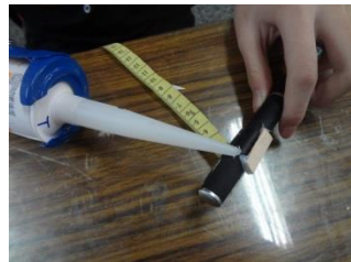
圖 4：改做成能移動測量的方式，將布尺固定在雷射筆上直接測量
