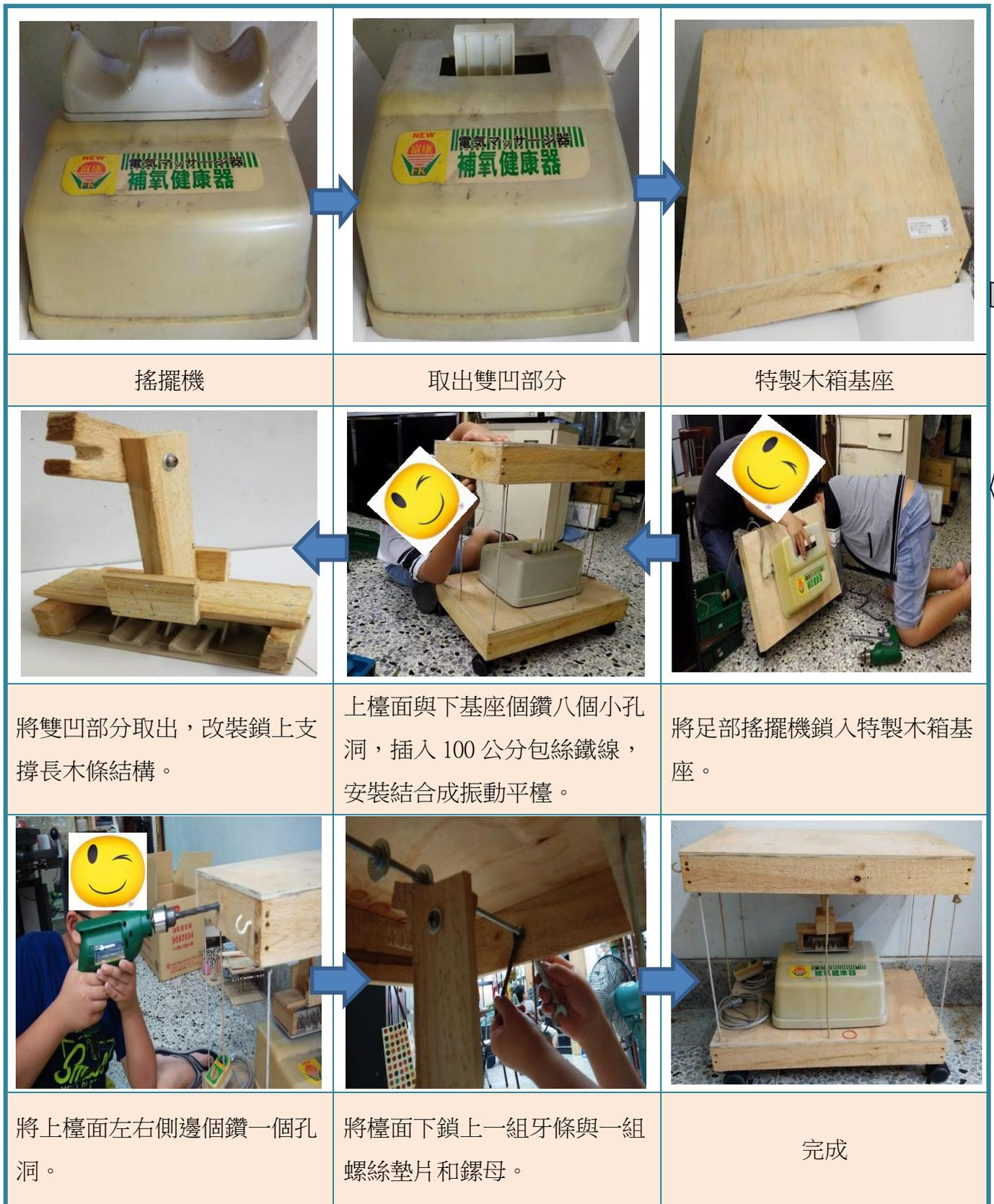
圖 2 自製模擬振動平台流程圖
