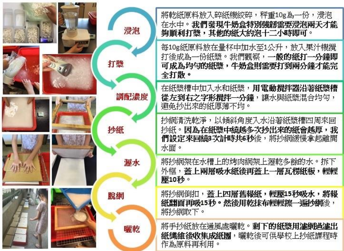
圖 2-2-1：標準化的抄紙流程
