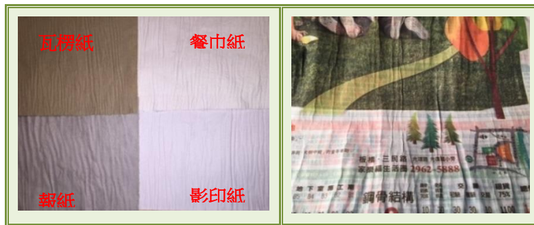
圖 2-1-1：四種原料的手抄紙和報紙吸水後的皺摺
