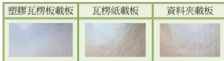
圖 2-1-2：不同載板製作的手抄紙之皺摺
