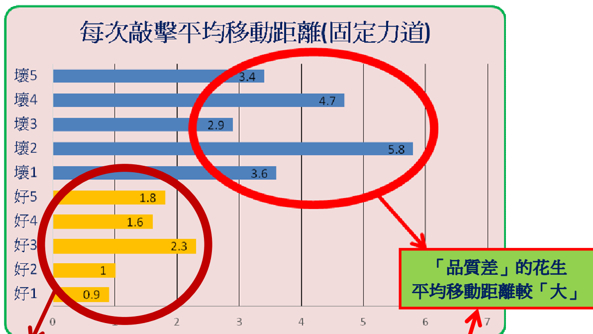
圖 4-6-5：固定力道時，花生每次敲擊的平均移動距離
