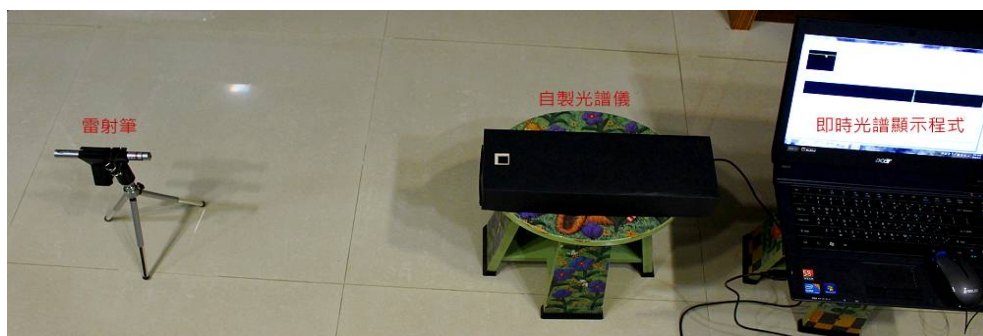
圖 15-1 自製光譜儀的準確度測試裝置圖
