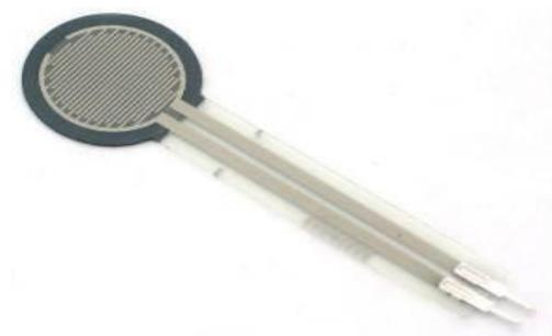
圖 2 壓力感測器 Interlink 402 實體圖
