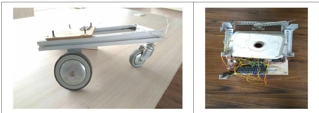
圖 30 第一代萬向輪，測試結果機體翻倒損壞
