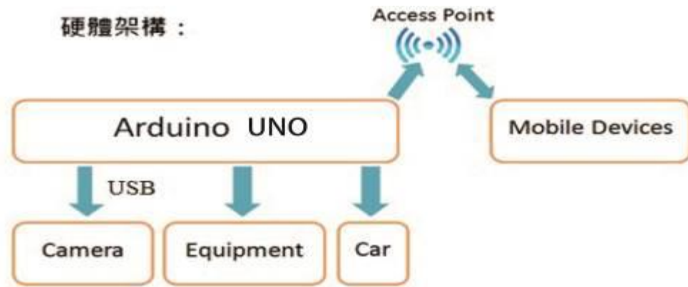
圖 4 Arduino 元件組硬體架構控制流程
