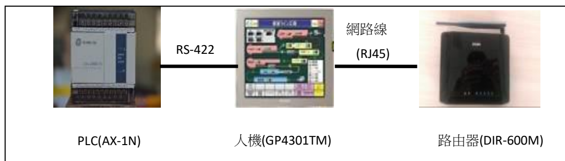
圖 10 WIFI 傳輸控制流程
