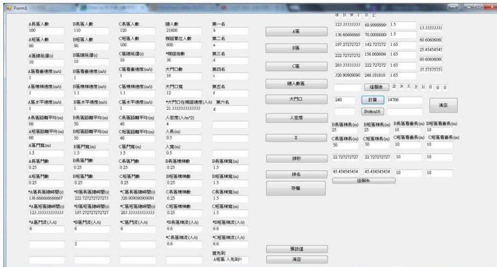
圖八：操作介面，本研究先用預設值（基礎資料）在開始調控變因之後按下按鈕（這個先），在依序計算A B C三區總時間，再按下（排秒）按鈕來排先後順序，再按下（排名）按鈕來注入數據，移動到右上的計算區按（這個後）按鈕，再按（計算）按鈕，即可求出多少秒以內，可安全避難人數為多少人。
