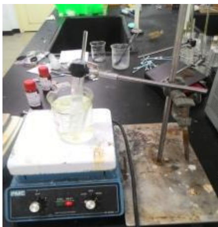
圖(十)：膽固醇型液晶隔水加熱
