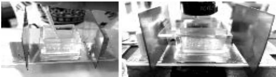
圖 06：玻璃座平行銅片電場第四代裝置, 滴入液滴（左），晶體成長實況裝置（右）
