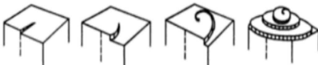
圖 30：階梯螺旋紋的成長機制，主要是發生在較低的過飽和度下與光滑界面晶體上
