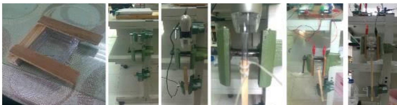
圖 01：第一代到第三代平行板電場裝置與觀察攝(錄)影裝置設計的演變過程
