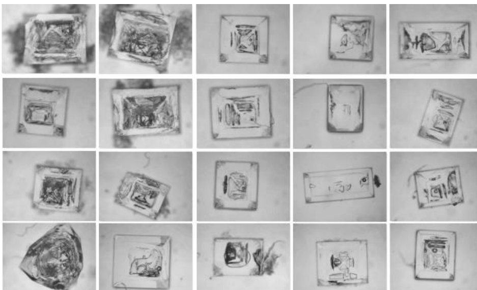
圖 51：顯微鏡下，無施加高電壓平行電場（電壓=0 伏特）的溴化鉀液滴晶體成長影像
