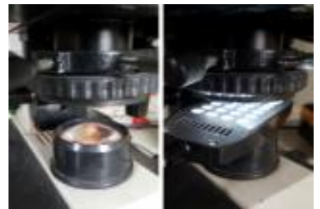
圖 13：兩種不同光源的顯微鏡照明
