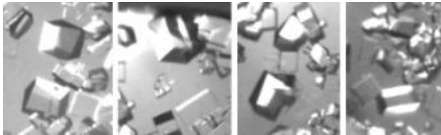
圖 23：研究 1-7 無過濾食鹽溶液，晶體成長時間 118 分鐘後，液滴邊緣長出晶體的照片
