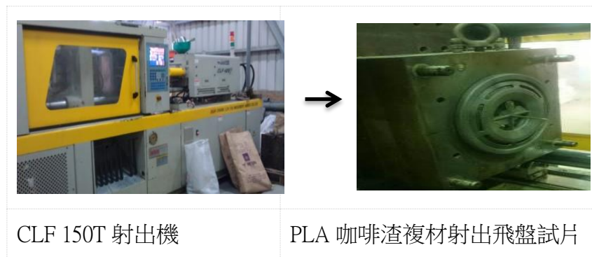
圖 4、PLA 咖啡渣複材射出飛盤成品。
