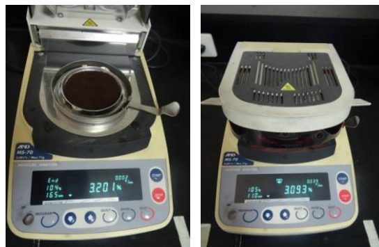
圖 9、咖啡渣乾燥後含水率約 3.09% (以紅外線 105°C 約 1.7min 平衡)。
