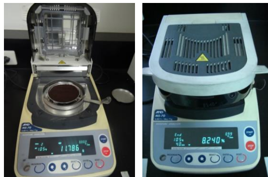
圖 8、咖啡渣乾燥前含水率約 8.24% (以紅外線 105°C 約 3.7min 平衡)。
