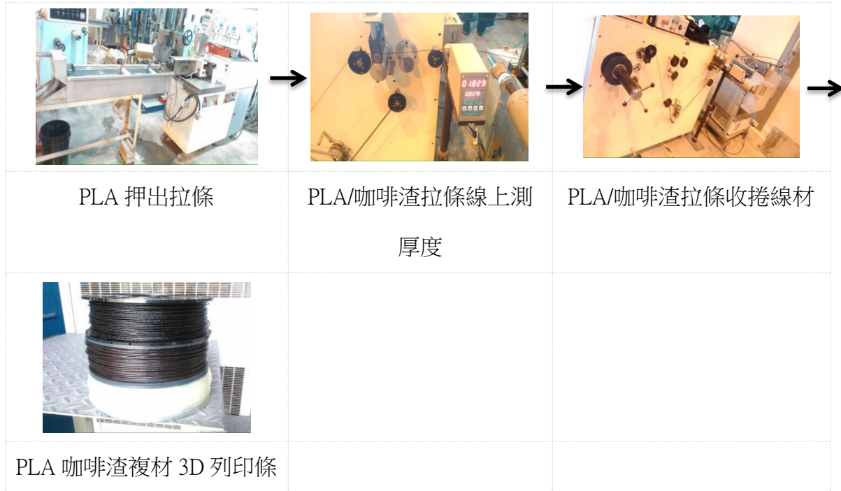
圖 6、單螺桿押出機製備 PLA 咖啡渣複材 3D 列印條。
