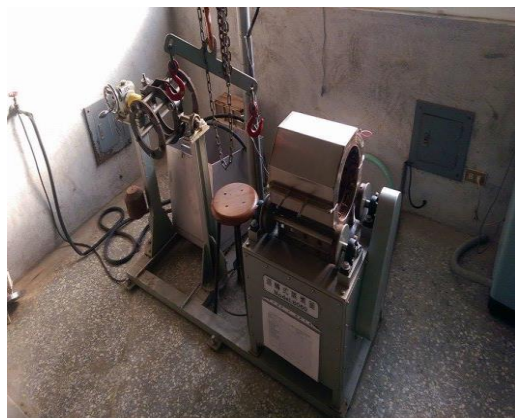
圖 2. 化工科化工裝置實驗室的迴轉式加熱器。
