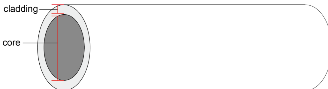
圖3 光纖結構示意圖
