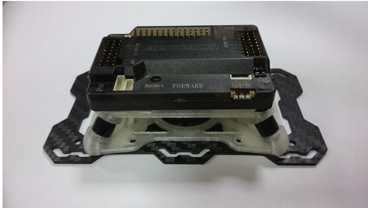
圖十三 自行印製組裝的減震座
