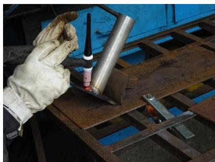
圖 22 排氣管接頭焊接
