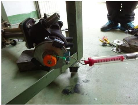
圖 12 彈簧秤量測渦輪軸壓力
