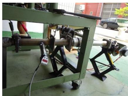
圖 39 渦輪發電機背壓測量
