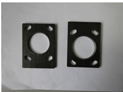
圖 21 排氣管接頭加工成果
