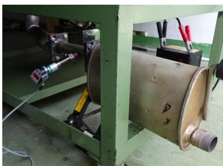
圖 38 消音器背壓測量
