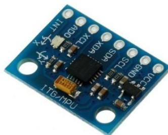
圖 7 MPU6050 加速度計
