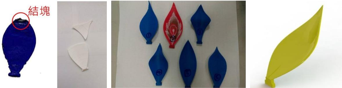
圖 38.花瓣結塊現象 圖 39.太薄容易斷 圖 40.表決最佳造型花瓣 圖 41.最佳造型花瓣誕生
