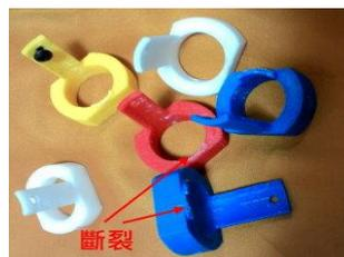
圖 44.斷裂之凸輪連接件
