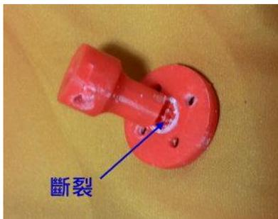
圖 46.斷裂之馬達連接件
