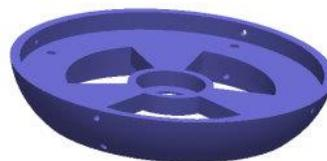
圖 36.修正後之圓弧型連接件
