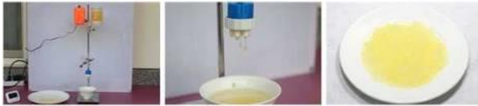
圖 23 利用自製的自動化機械可快速且大量地生產鳳梨珍珠
