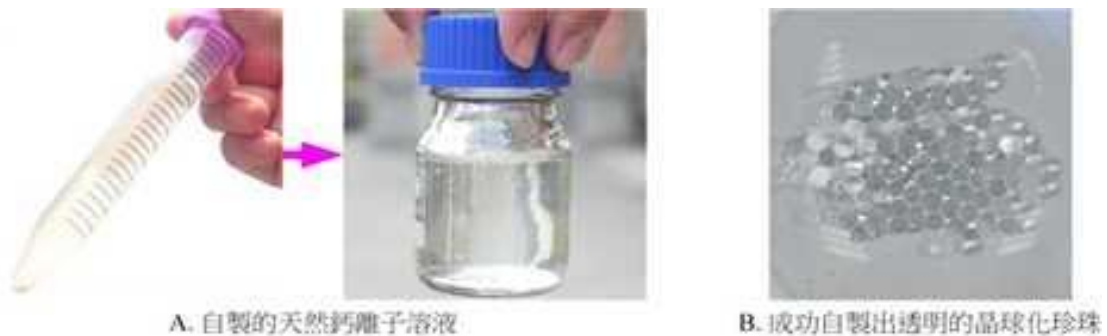
圖 2. 利用自製蛋殼鈣溶液製作品球
