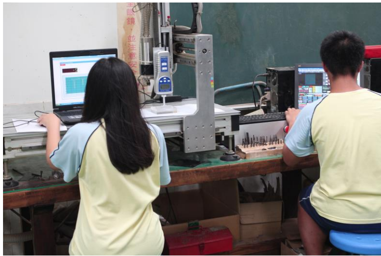
以推拉力計整合 CNC 雕銑機自製物性測定儀，測試晶球之物性。
