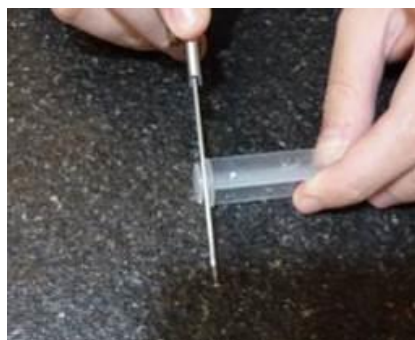
圖一：切除活塞和針筒連接處
