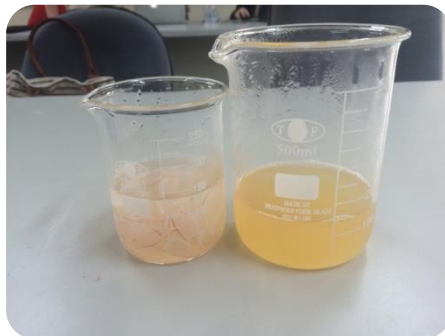
圖 7 將去乙醯化後的蝦殼撈起，放入水中
