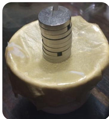
圖 12 以砝碼來測試其最大耐重量
