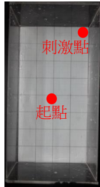
圖三、透明壓克力盒俯視圖，實驗二與三的裝置，底部為方格紙，實驗時渦蟲放置於起點，控制變因置於刺激點
