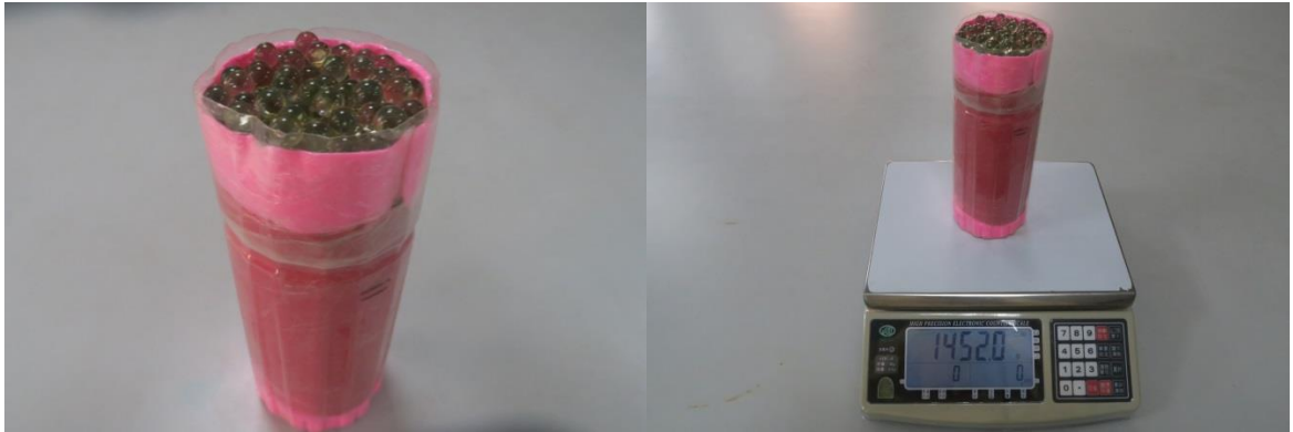
▲圖三量測容器內部鋪設黏土，降低顆粒與管壁間增加之孔隙，更為貼近地層之真實環境，進行孔隙率與出水率量測。
