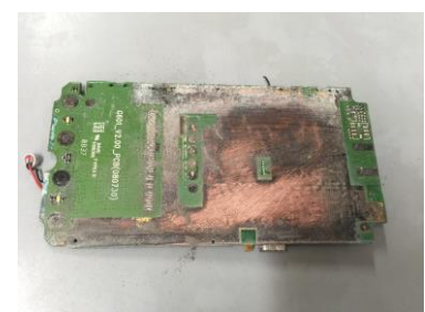
圖 5-4-3 刮除黑垢看見銅箔基板
