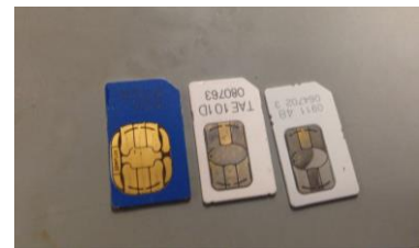
圖 5-4-1 剝金前後的 SIM 卡
