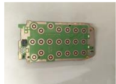
圖 5-4-2 剝金後的手機基板
