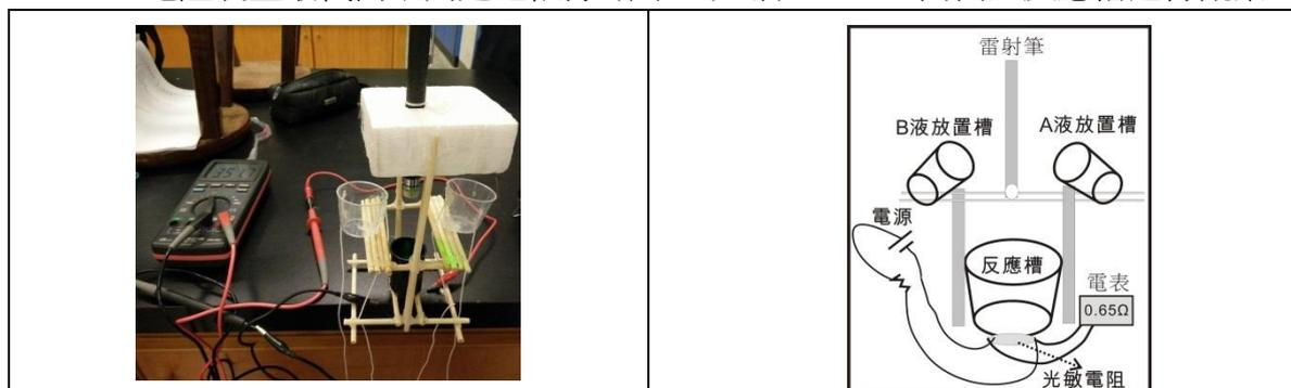
圖 27、光敏電阻為判讀依據進行碘鐘反應圖示。
