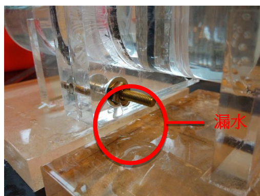
圖. 21 螺絲附近有漏水問題
