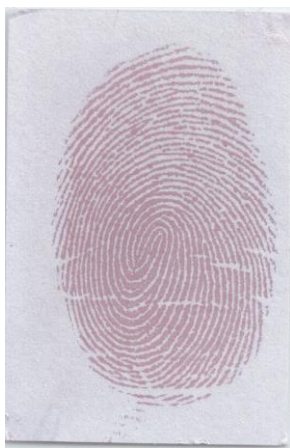
圖三十一 浸泡四氯金酸溶液兩小時所顯現的潛指紋
