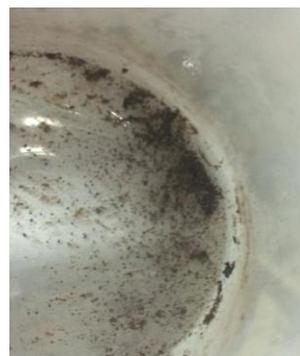
圖 14 錳分子模板經由晾乾後，再經由研磨及篩選過程即可得到對特定重金屬具有高度專一性之分子模板。
