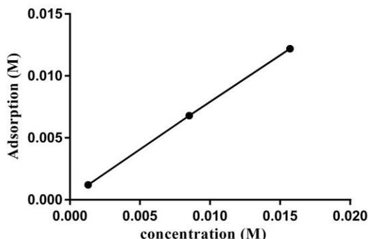
圖 45 在相同分子模板克數下，於不同銅離子濃度下測量。
