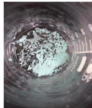
圖 11 銅分子模板經由晾乾後，再經由研磨及篩選過程即可得到對特定重金屬具有高度專一性之分子模板。
