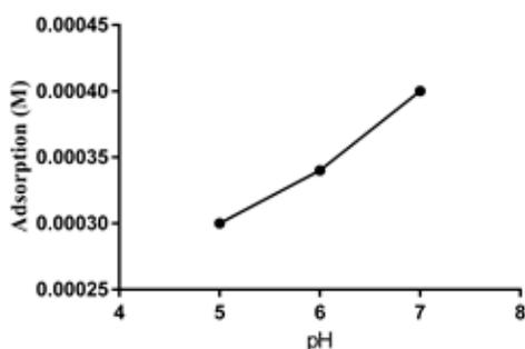
圖 57 鉛在不同 pH 值下測量
