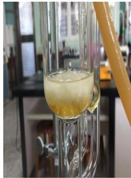
圖 19 將鉛分子模板利用索氏萃取器進行重金屬脫附，以形成具有專一性之孔洞。
