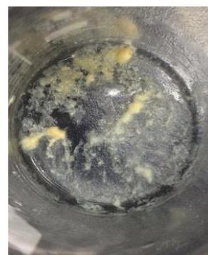
圖 17 鋅分子模板經由晾乾後，再經由研磨及篩選過程即可得到對特定重金屬具有高度專一性之分子模板。
