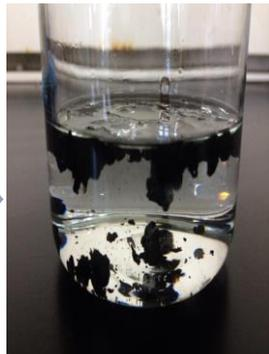
圖 6 氯化鐵及氯化亞鐵溶液放入 NaOH 中反應並形成氧化鐵磁顆粒。
