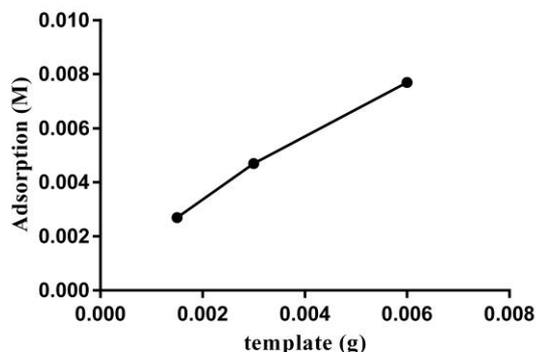
圖 46 在相同銅離子濃度下測量，於不同克數分子模板下測量。
