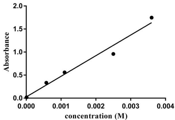
圖 37：錳主要吸收值(波長)檢量(波長 279.5 nm)
