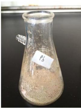
圖 27 聚合完成之磁性鉛分子模板。
