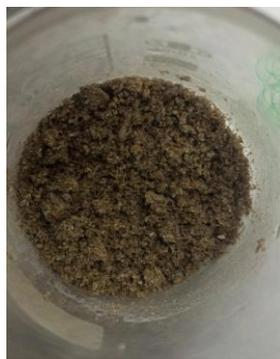
圖 28 萃取完成之磁性鉛分子模板粉末。
