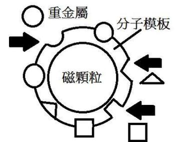
圖 1 磁性分子模板示意圖
