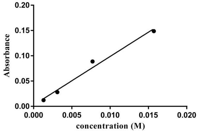
圖 36：銅主要吸收值(波長)檢量線(波長 324.5 nm)
