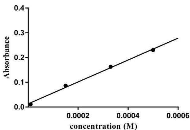
圖 39: 鉛主要吸收值(波長)檢量線(波長 283.3 nm)
