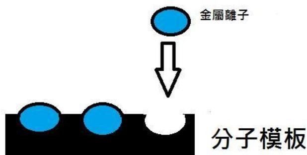
圖 44 分子模板示意圖，分子模板因為在聚合過程中加入重金屬，因此並會吸附特定重金屬。
