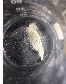
圖 20 鉛分子模板經由晾乾後，再經由研磨及篩選過程即可得到對特定重金屬具有高度專一性之分子模板。
