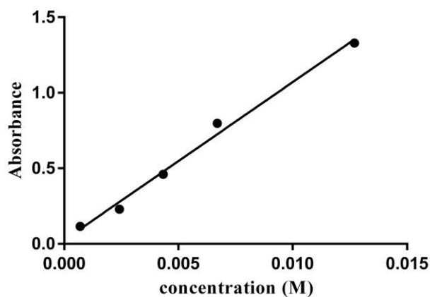
圖 38: 鋅主要吸收值(波長)檢量線(波長 213.9 nm)
