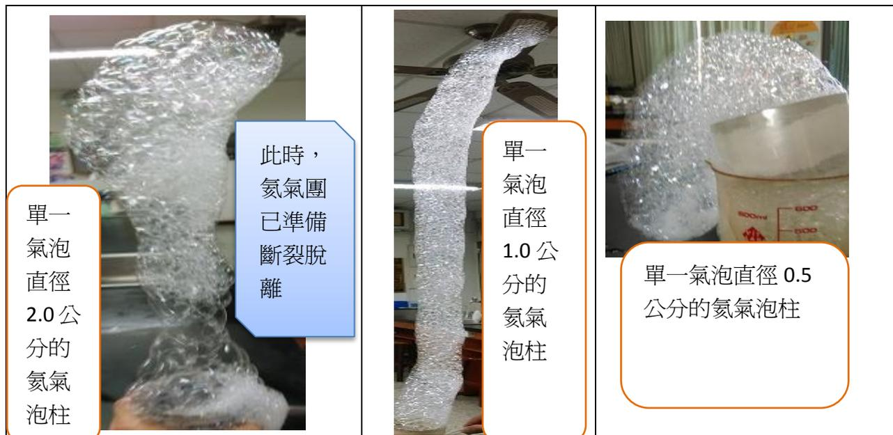
圖五：左圖是因單一氮氣泡過大，浮力過強，氮氣團已預備脫開、分離，且也難以塑形；右圖則是因氮氣泡小，雖可塑形，維持時間也夠久，但因浮力小，下垂飄不起來。中圖則是浮力適中，氮氣柱可上飄、且不斷裂，也可塑形。
