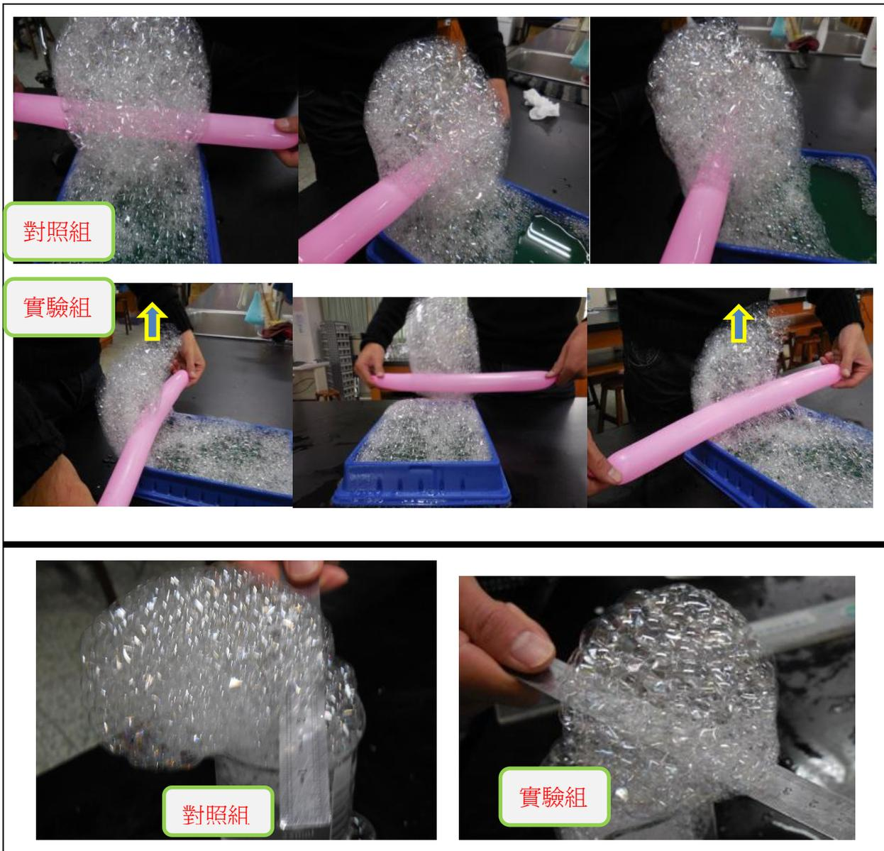
圖八：上方氣球的圖中，乾燥與否，會影響能否切割分離氣泡團。且在上方的實驗組中，被乾燥的氣球，切割過的氦氣泡團，會出現上揚，要自行分離的現象出現。下方鐵尺的圖中，乾燥與否，則與能否切割分離氣泡團無關，都無法有效切割。
