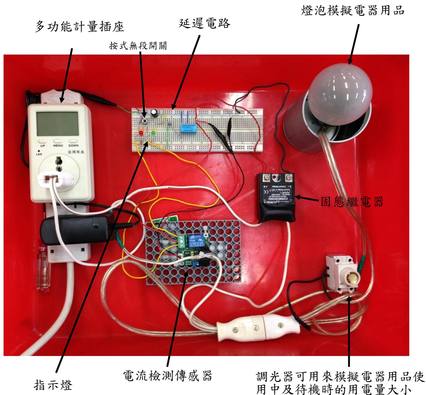
圖二十 待機電器自動斷電系統 作品
