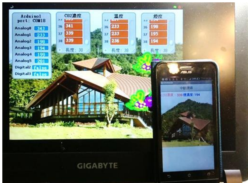
圖三十二、本系統可以將污染訊號透過藍芽即時傳遞至手機
