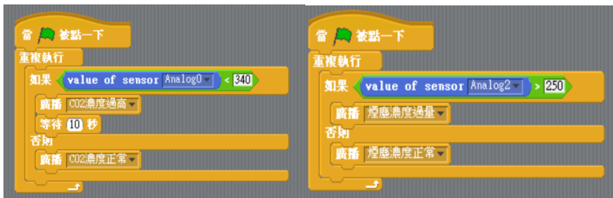
圖二十四、當二氧化碳或煙霧含量超於正常值時，立即發布汙染文字提醒 (CO2 濃度過高一電壓值小於 340、煙塵濃度過量一電壓值大於 250)
