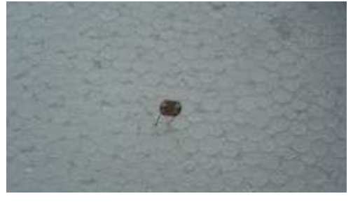
圖 4-9 中顆光敏電阻（直徑 11mm）
