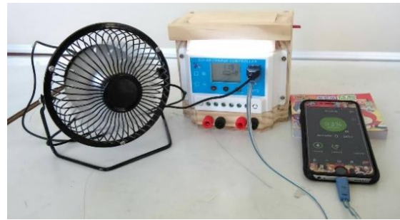
圖 53C 轉成 110V 交流電作為家庭之用 圖 53D 5V USB 電源可用於手機充電或小型風扇 圖 53 發電之生活應用
