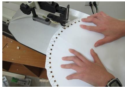
B、在沖孔處鑽孔，方便鋸切
