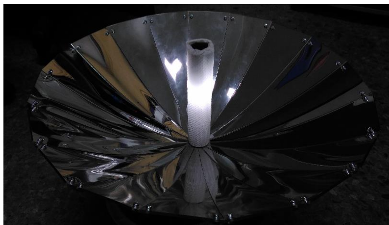
圖 28 室內日光燈下，光線在紙軸上聚焦的情形。雖日光燈下非平行光，但仍可容易看出聚焦的效果。
