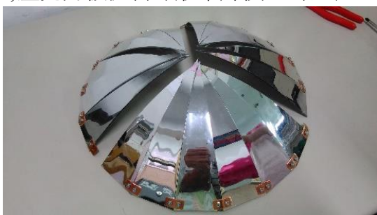
A、開口端先以銅片、螺絲連結
