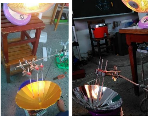
圖 55A 以赤外線燈對準爐心，調整 赤外線燈與爐心的距離為 100 cm
