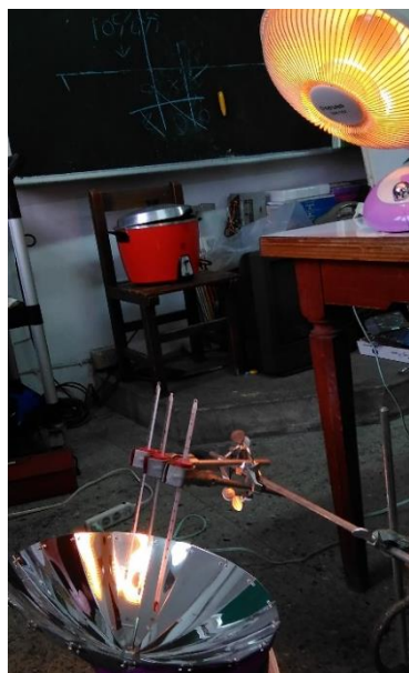
圖 26 赤外線燈對太陽爐作焦點溫度測試裝置圖
