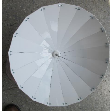
2、18片壓克力板拋物線形模組合
