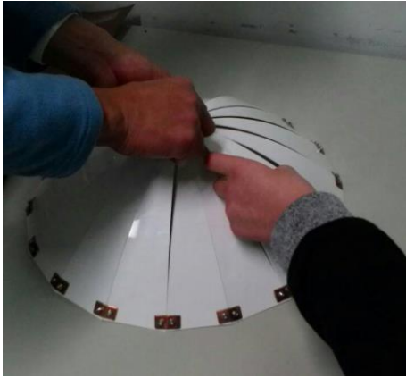
1、開口端先以用銅片、螺絲連結， 底端用熱熔膠黏著。
