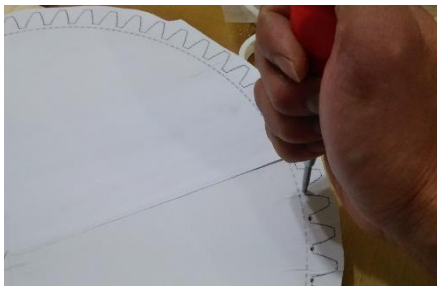
A、將齒輪模板用膠水貼於木合板並在兩齒之間沖孔
