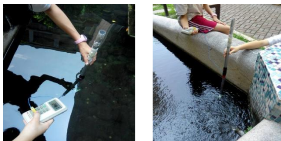
圖 5-20：不同水深的溫度測量實驗照
