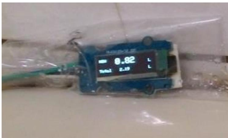
圖 11 將 OLED 顯示幕配線加長，以防水塑膠袋裝好
